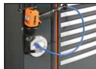
Sűrített levegős csatlakozó Ø 8 mm tömlődobbal. Hosszúság: 10 m
